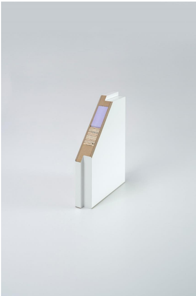
Bild 4: Das Deck der Huga Energiespartür besteht aus einem Verbundelement zweier hochdichter Fassaderplatten (HDF) mit Alu-Dampfsperre.
