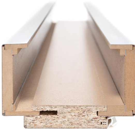
Bild 3: Die Rückseite des Futterbretts ist mit Melaminharz beschichtet und verhindert somit die Feuchtigkeitsaufnahme aus der Wand.
