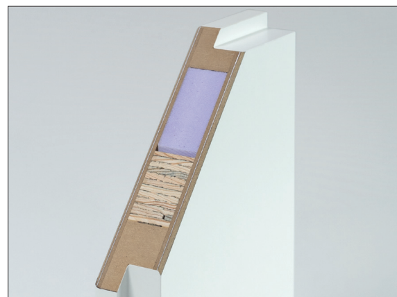
Türaufbau Energiespartür
